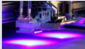
La testina di stampa è dotata di **due lampade UV Led raffreddate a liquido** per asciugare l'inchiostro già in fase di stampa senza ulteriori lavorazioni, risparmiando tempo, denaro ed incrementando la produzione.
