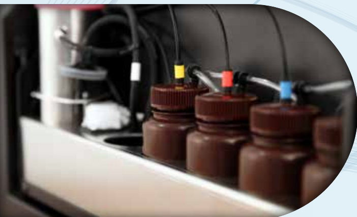
Ricircolo del bianco + sistema pressurizzato
